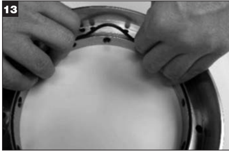
Удалите стопорное кольцо уплотнительного кольца (Y) и утилизируйте.
