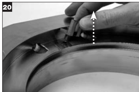
Удалите узел привода из сальника и утилизируйте.
