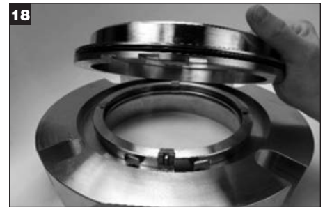
Удалите адаптер из сальника. Удалите уплотнительное кольцо адаптера (Z) и утилизируйте. Отложите адаптер в сторону.
